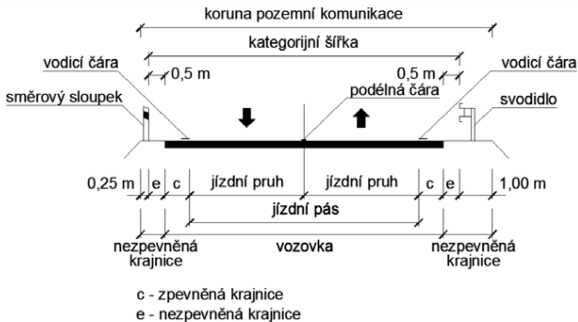
Obr. 5.2 Dvoupruhová, směrově nerozdělená komunikace – příčný řez. (© ČSN 73 6101)
