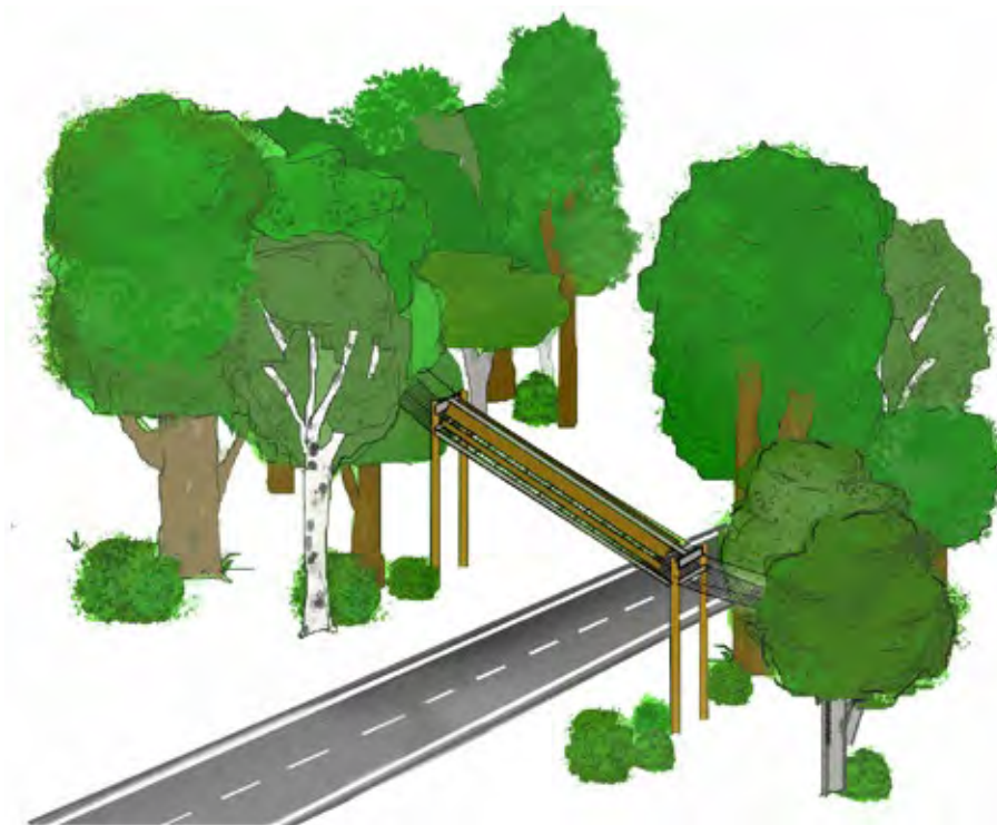
Obr. 6.23 Speciální nadchod pro plchy, který propojuje koruny stromů a poskytuje jim ochranu před predátory, je opatřením proti fragmentaci jejich populací. (Zdroj: www.animexbridge.com , upraveno)
